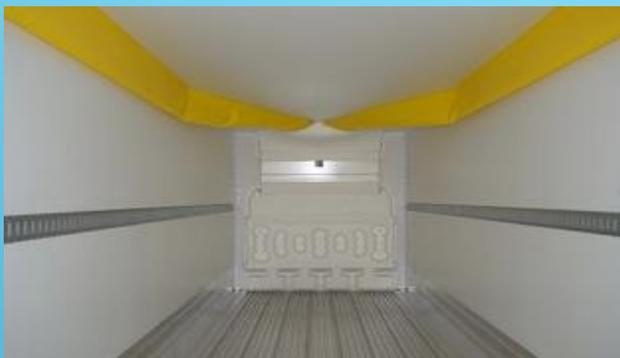
Il flusso di aria è garantito dalla caratteristica pavimentazione del container composta da un profilato di alluminio
